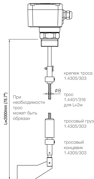
Поз.39 монтажный комплект "тросовое удлинение"
