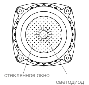
Поз.27 б светодиод (стеклянное окно в крышке)
